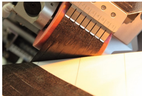
Abbildung 2: Automatisierte, robotergestützte Faserablage von faserverstärkten Deckschichten © Fraunhofer IGCV, Augsburg / Bernd Müller
