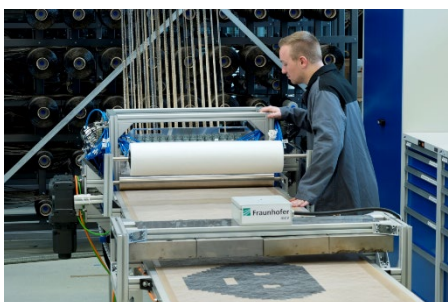
Bild 3: Continuous Fiber Tailoring (CFT) ist ein vom Fraunhofer IGCV entwickeltes hocheffizientes Verfahren: endkonturnahe Carbonfaser Preforms, mit denen CFK-Bauteile gefertigt werden, lassen sich mit diesem Verfahren automatisiert herstellen. | Copyright: Fraunhofer IGCV
