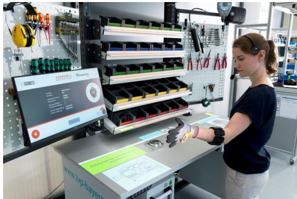
Abbildung 1: Der Montagetisch vom Fraunhofer IGCV bietet Mitarbeitern die Möglichkeit, verschiedene Assistenzsysteme zu testen und zu vergleichen. Bildnachweis: Fraunhofer IGCV / Bernd Müller Fotografie
