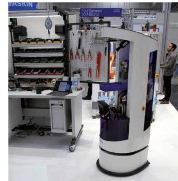
Mobiler Roboter bei Anlieferung an interaktiven Montagearbeitsplatz
