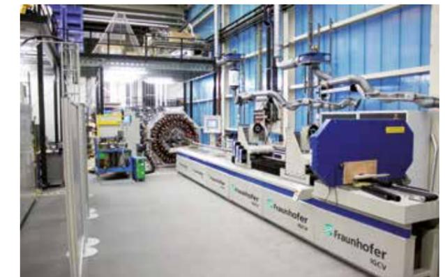
Industrielle Pultrusionsanlage beim Fraunhofer IGCV
