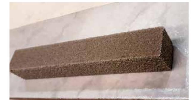
*Gedruckter Biegeriegel aus einem neuartigen Formstoffsystem auf der Basis eines Phenolharzbinders*
