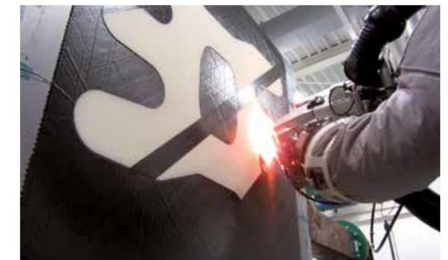
*Automated Fiber Placement Legeprozess eines Schalenbauteils mit komplexer Kernstruktur*
