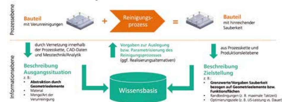
Modellierung und Nutzung der ermittelten Zusammenhänge am Beispiel der Auslegung und Parametrisierung einer Anlage
