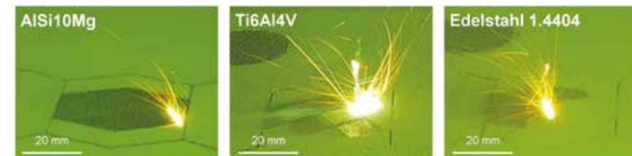
Bildung von Prozessspritzern beim Laserstrahlschmelzen
