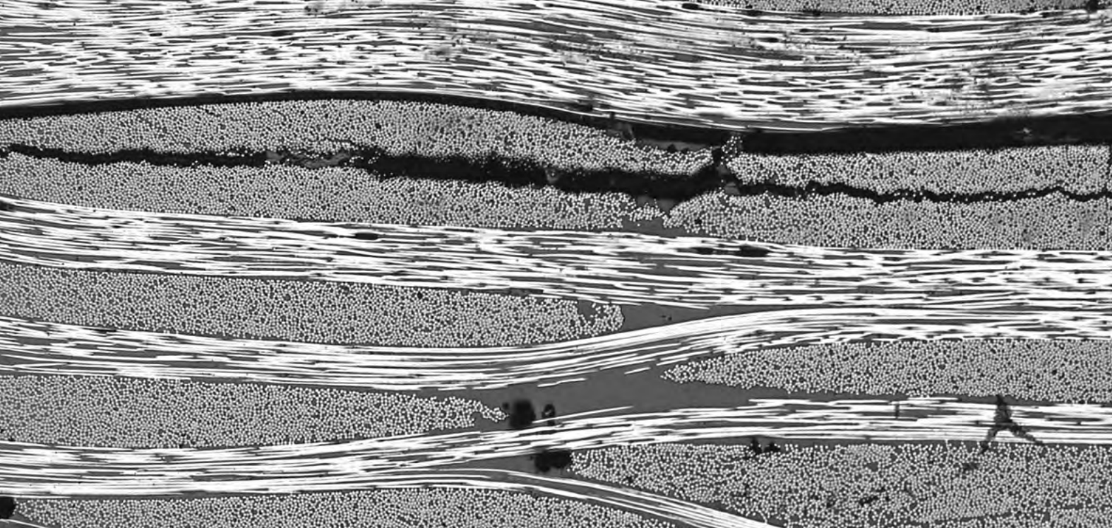
Querschliff durch eine Probe aus CFK
