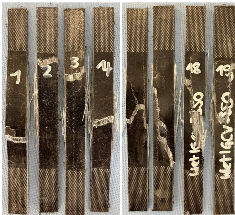
Abb. 53: Bruchbilder der Zugproben (links: Unifilo, rechts: WetGCV_350g_neu).
