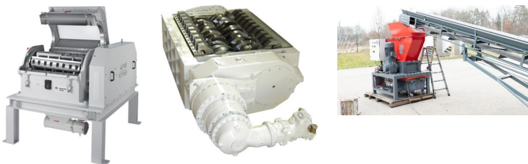
Abb. 3: Die verwendeten Zerkleinerungsmaschinen mit der Schneidmühle von Hosokawa Alpine 2 (links) und den Zweiwellenzerkleinerern von Erdwich 1 (Mitte) und den Aufbau für den zweistufigen Prozess (rechts).
