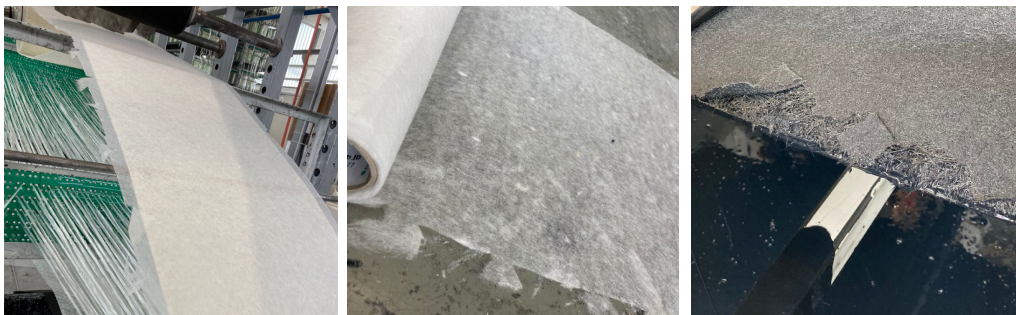
Abb. 40: Randfaserbrüche und Einreißen des Nassvlieses als Fehlerbild während der Nassvlieseumformung.
