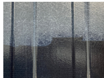
Abb. 42: Übergang rGF-Nassvlies (oben) zu PA-Vlies (unten), sowie im nassen Bereich (links) zum ausgehärteten Profil (rechts).
