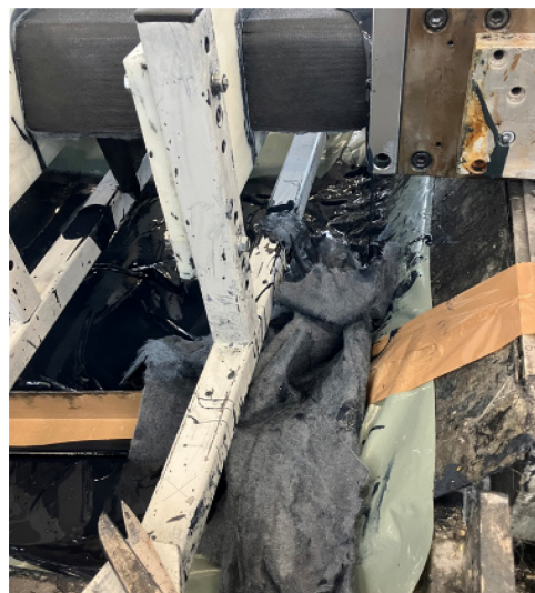
Abb. 44: Prozessabbruch aufgrund einer zu niedrigen Zugfestigkeit des 320 g/m 2 Nassvlieses.
