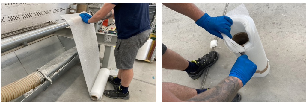
Abb. 38: Vorbereitung des Nassvlieses für die Pultrusion.
