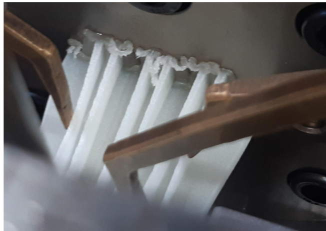
Abb. 31: Bartbildung bei der Extrusion.
