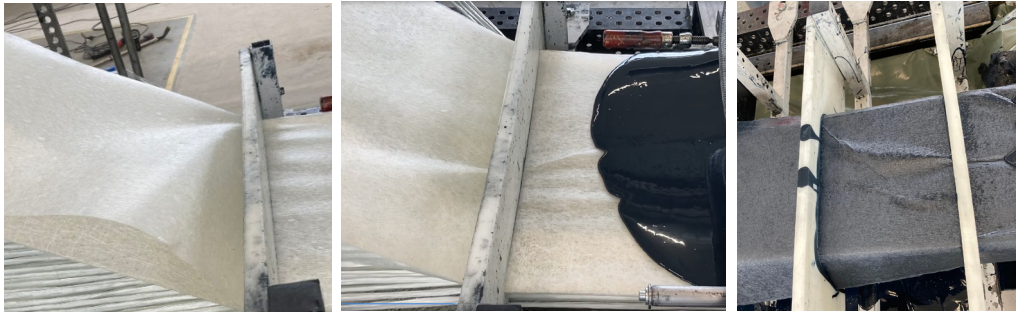
Abb. 39: Faltenwurf als Fehlerbild während der Nassvlieseumformung.
