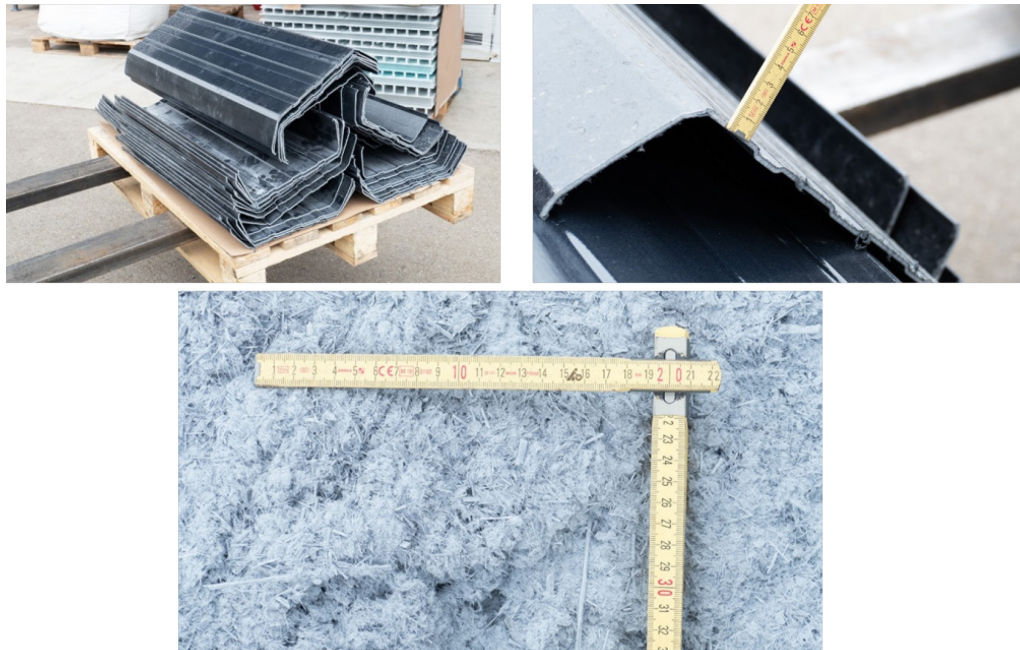
Abb. 6: Bilder der Langgutwanne (oben) vor der Zerkleinerung und nach der Zerkleinerung (unten).
