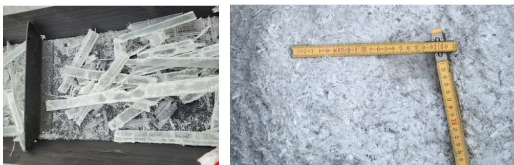
Abb. 7: Die vorzerkleinerten Industrietore der Firma Butzbach (links) und feinerzkleinert (rechts).
