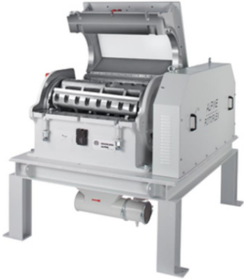
Abb. 8: Einstufig (oben) und zweistufig (unten) zerkleinertes Material der Firma Butzbach und die verwendete Schneidmühle der Firma Hosokawa Alpine (rechts).
