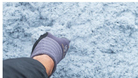
Abb. 4: Zerkleinertes Organoblech nach der Vorzerkleinerung (links) und nach der Feinzerkleinerung (rechts).
