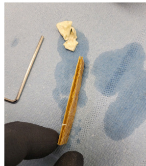
Abb. 16: Solvolysierte Glasfasern mit nicht vollständig zersetzten Polyesterharzresten führt zu gelblicher Verfärbung.
