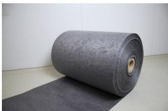
Bild 3: Vliesrolle aus der Nassvliesanlage © Fraunhofer IGCV
