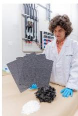
Bild 1: Verarbeitung von Hybridvliesen aus recycelten Carbonfasern und thermoplastischen Matrixfasern © A3/Christian Strohmayer
